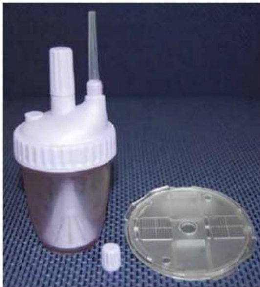
Figuur 2: Links: Fill-FLOTAC recipiënt; Rechts: mini-FLOTAC-telkamer. Uit: Barda et al., 2013.
