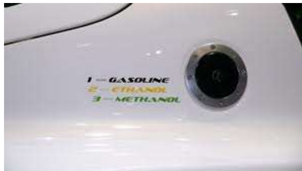
Figuur 2: Detail van bovenstaande wagen met de ternaire componenten Benzine-Ethanol-Methanol
