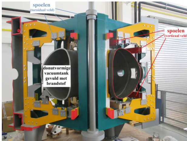
Figuur 1: Houten model van COMPASS ( links ) en foto van het echte toestel ( rechts ). Zoek de laptop om de afmetingen te kunnen inschatten.
