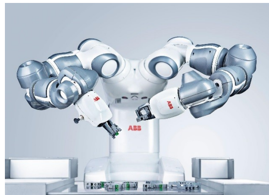
Figuur 2: YuMi; de nieuwe cobot van ABB, ontworpen voor de assemblage van elektronica.
