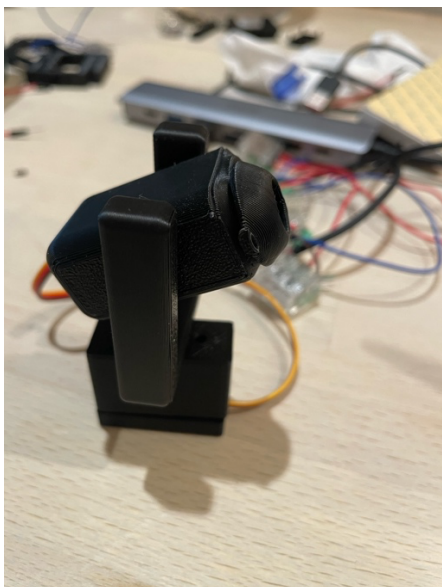
Figuur 32 eerste montage van movinghead
