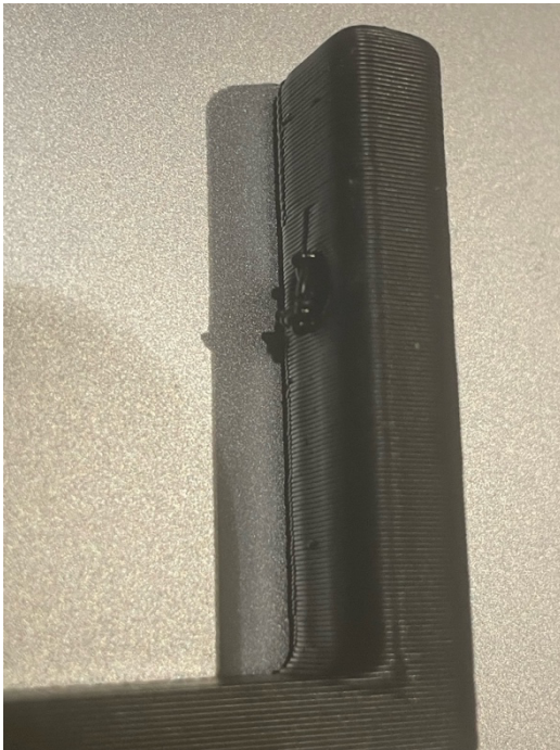
Figuur 14 Print met 0.6 nozzle
