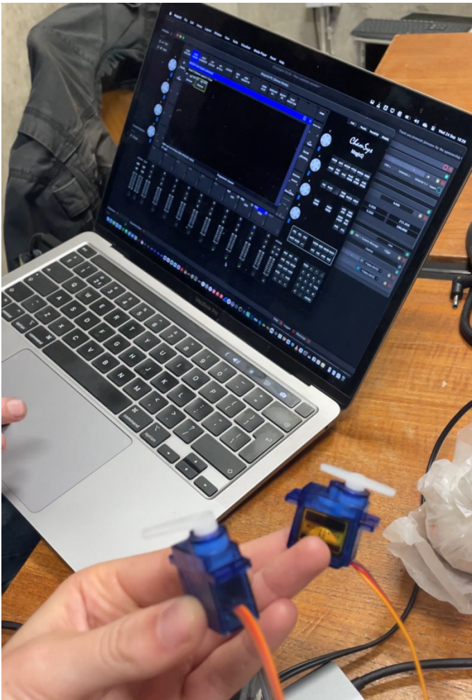
Figuur 19 Beide motoren worden aangestuurd via Chamsys
