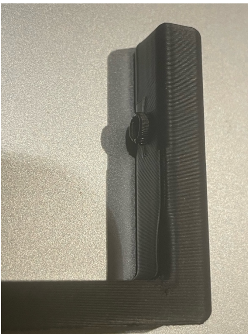
Figuur 15 Print met 0.4 nozzle
