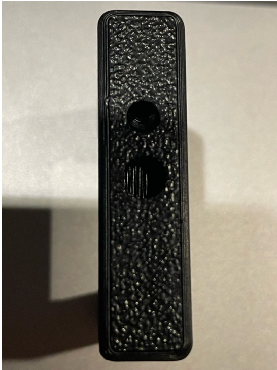
Figuur 16 Verticaal geprint
