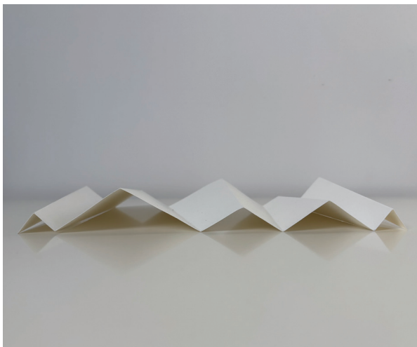
Figuur 2.41 Plooimaquette dakstructuur variant C
