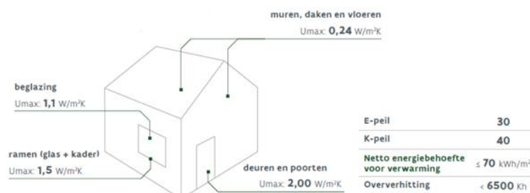
Figuur 2 Overzicht gebouwschil eisen
