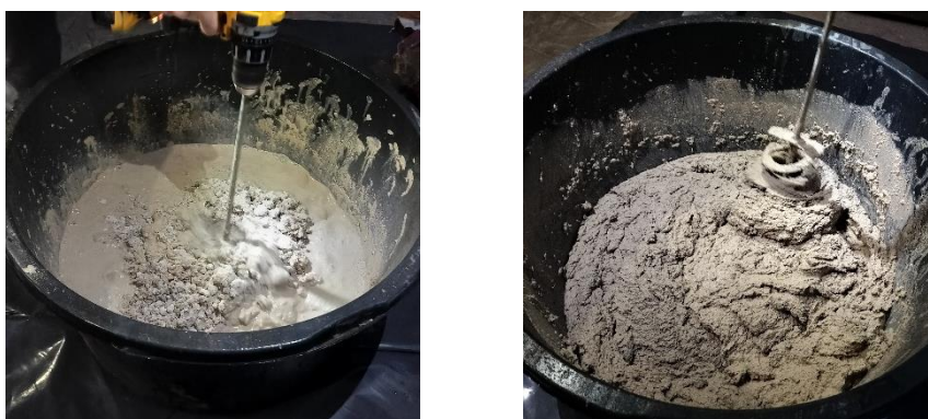
Figuur 51: Aanmaak van de pure kalkmortel met links de "deegbolletjes" en rechts de finale, gladde specie.
