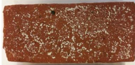
Figuur 22: Contactoppervlak tussen een baksteen en dry cured mortel, waarbij slechts 30% van het oppervlak effectief contact maakte. Dit gebrekkig contact verklaart o.a. de hygrische grensweerstand (Calle et al., 2019).
