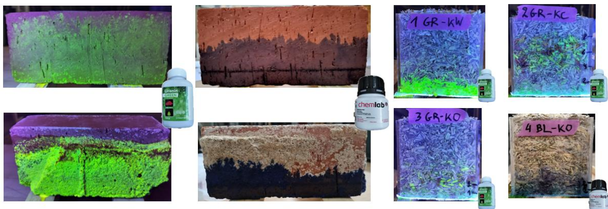
Figuur 66: resultaat van de absorptieproeven op baksteen en kalkhennep met de 2 kleurstoffen.
