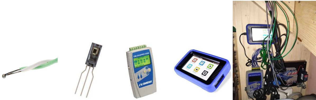
Figuur 130: V.l.n.r. thermokoppel K, HIH-4000, OM-DAQPRO-5300, OM-CP-OCTPRO en hun plaatsing (rechts).
