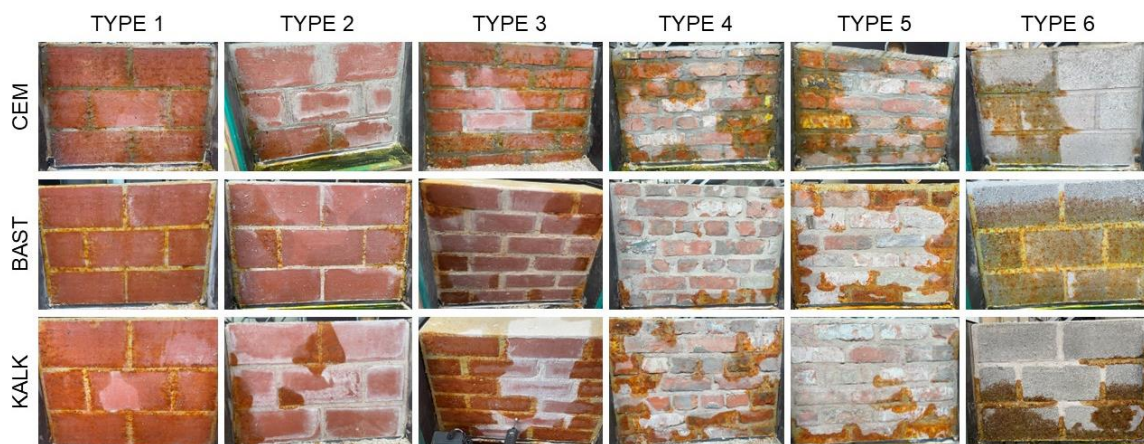
Figuur 73: Overzicht van de achterzijden van het metselwerk na de test.
