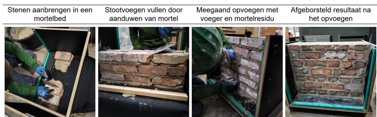
Figuur 53: Fotoverslag van het metselen van de testmuren met de belangrijkste stappen uitgelicht.
