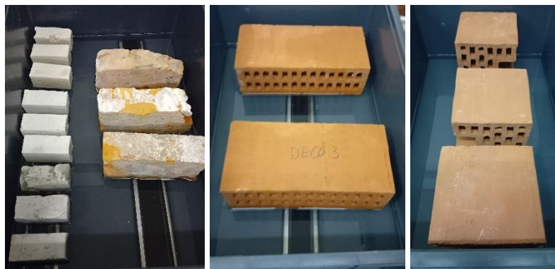
Figuur 69: De proefstukken tijdens de capillaire absorptieproef.
