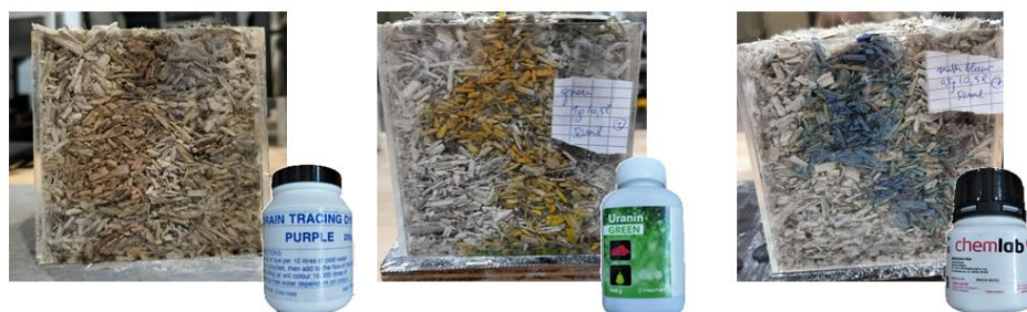
Figuur 65: Selectie tracer fase 1 - links niet voldoende zichtbaar, midden en rechts gewenste zichtbaarheid.
