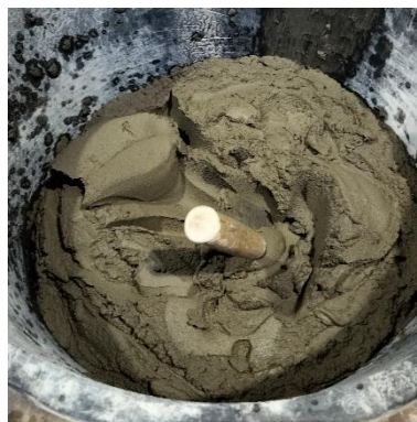
Figuur 49: De finale cementmortel, opmerkelijk donkerder van kleur door toedoen van het grijs cement.
