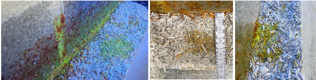
Figuur 85: Diepe infiltraties bij BAST 6 (links en midden) en CEM 6 (rechts).
