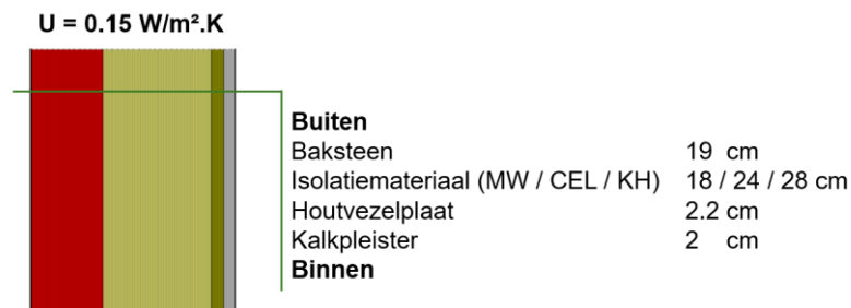
Figuur 104: Voorbeeld van de referentie-opbouw voor de one-factor-at-a-time approach (V9).
