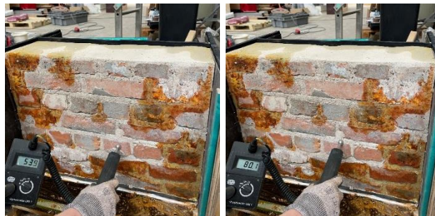
Figuur 75: Vochtmeting in een visueel droge zone waarbij de voeg vochtiger is dan de baksteen.
