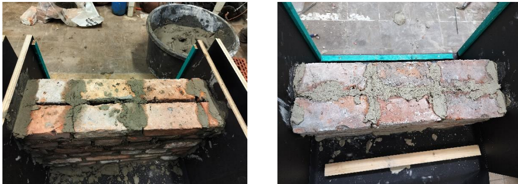
Figuur 54: Niet-gevulde hartvoeg in type 4 muur (links) en opgevulde hartvoeg in type 5 muur (rechts).
